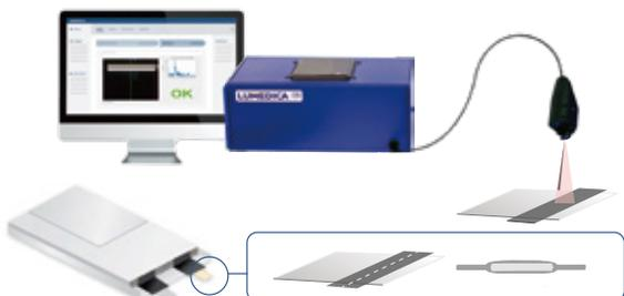
利用OCT近红外光源探测并通过回波干涉信号检测物体的表面轮廓与内部分层和粘接特征，50帧实时穿透薄膜材料截面成像，满足高效断层检测需求，清晰分辨贴胶正反以及分析贴合度，并提供专用图像算法与快判别软件
