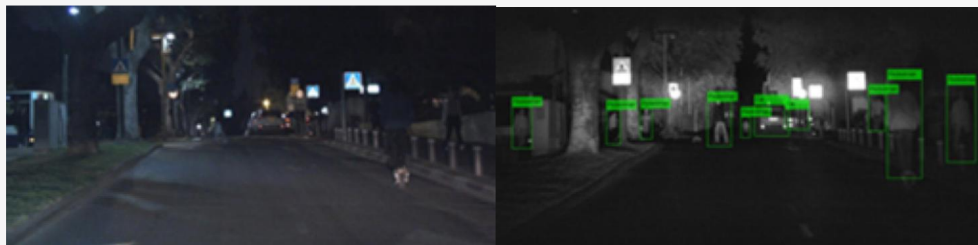
标准相机（左）与门控视觉相机（右）在夜间对行人和周围城市环境进行检测对比
