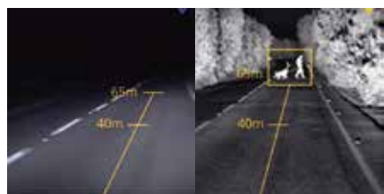
标准相机（左）与门控视觉相机（右）对比
